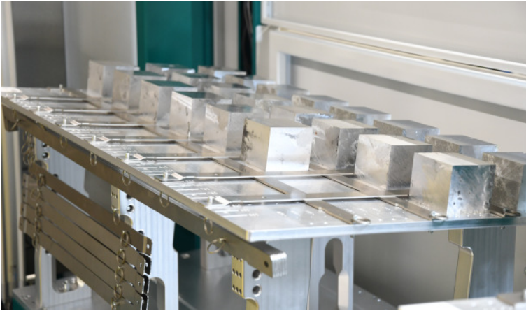
Rohteile warten im Magazin auf die Abholung
