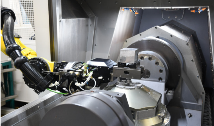
Rohteil im Zentrischspanner wird vom Roboter ins Nullpunktspannsystem eingewechselt
